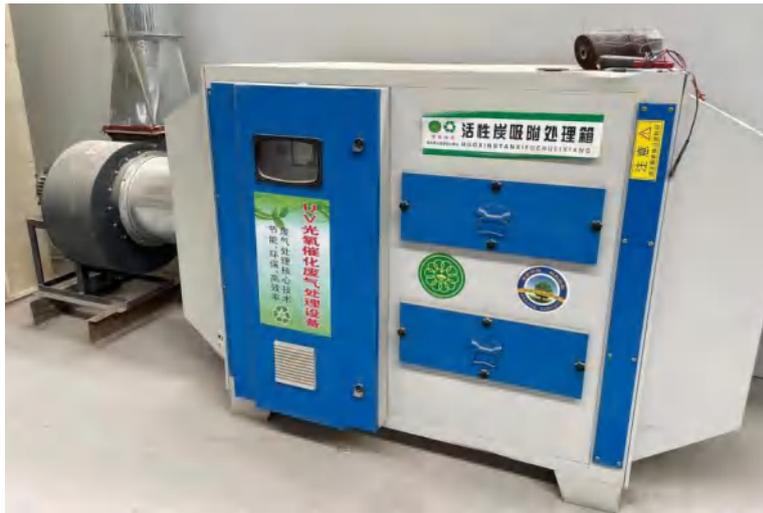
图 3-4 浸渍废气处理设施图
