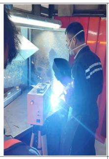
生产单元焊接区/手工弧焊岗
