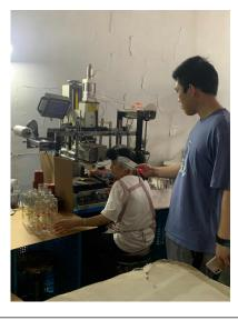
生产车间/热转印岗/热转印机
