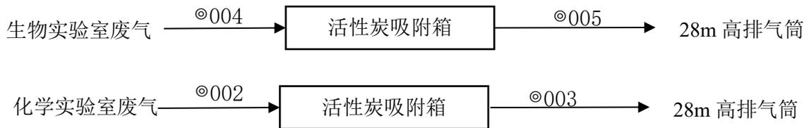
图 3-1 废气处理工艺流程图
